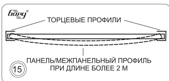
Установка последних панелей. 1-й способ: при длине панели более 2 м, завести один край панели в торцевой профиль, немного согнуть ее из плоскости вниз и вставить в второй торцевой профиль.
